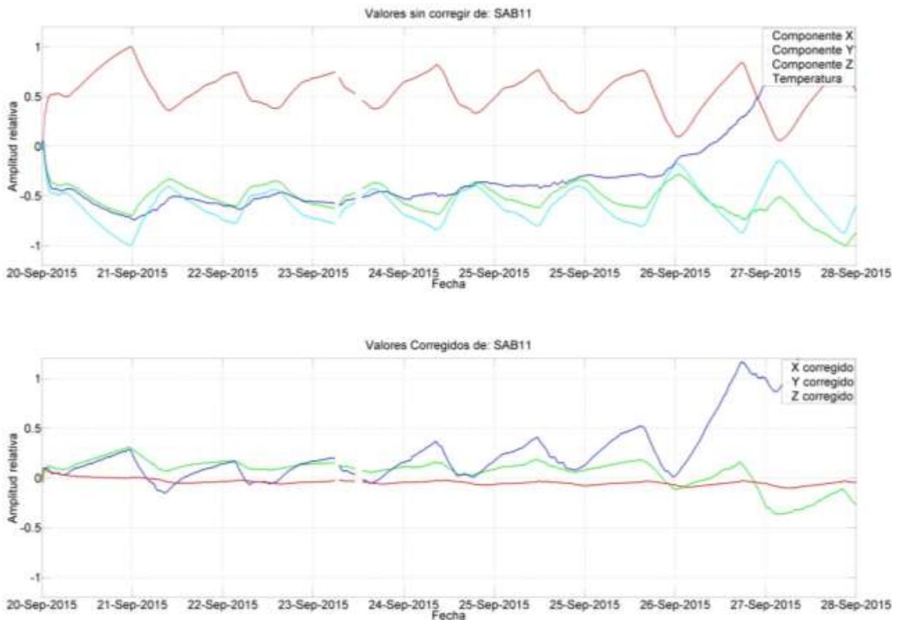
Figura 5.1. Valores de inclinación en las tres componentes registrados en la estación SAB11.
