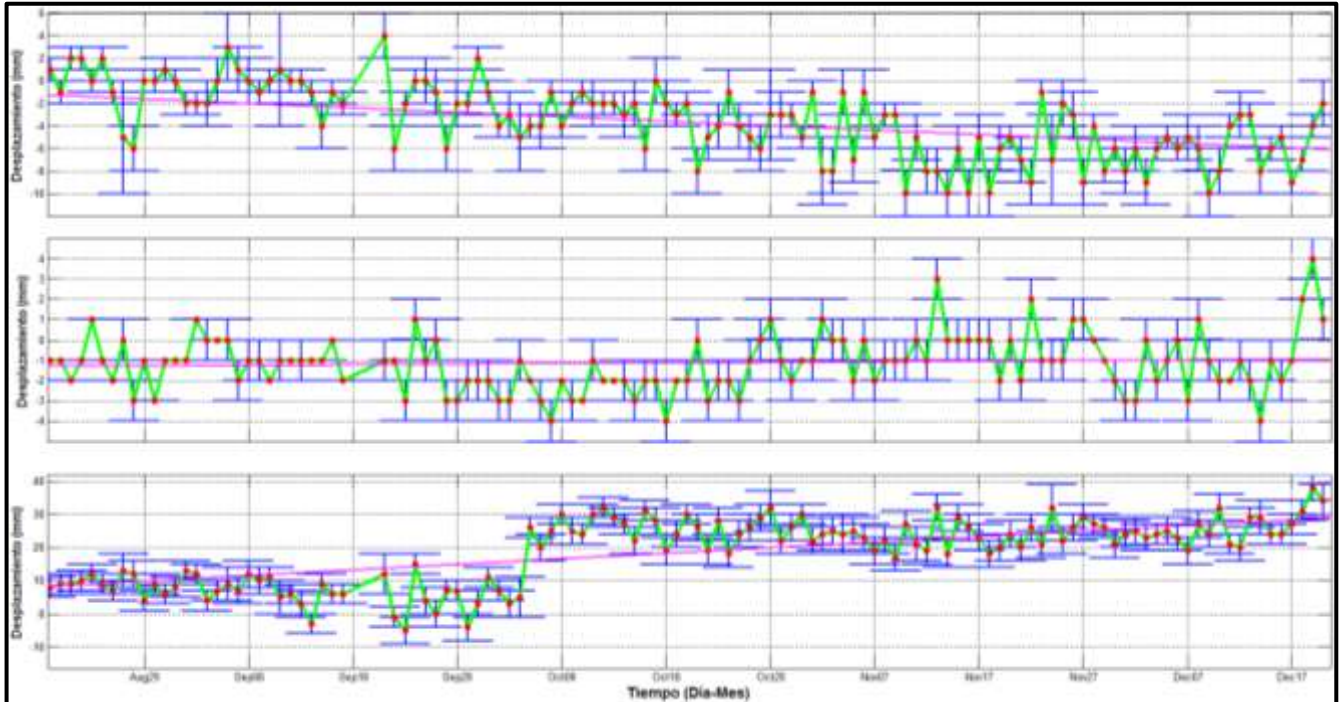
Figura 6.1. Comportamiento de las componentes de la estación de monitoreo GPS "UBGW".
